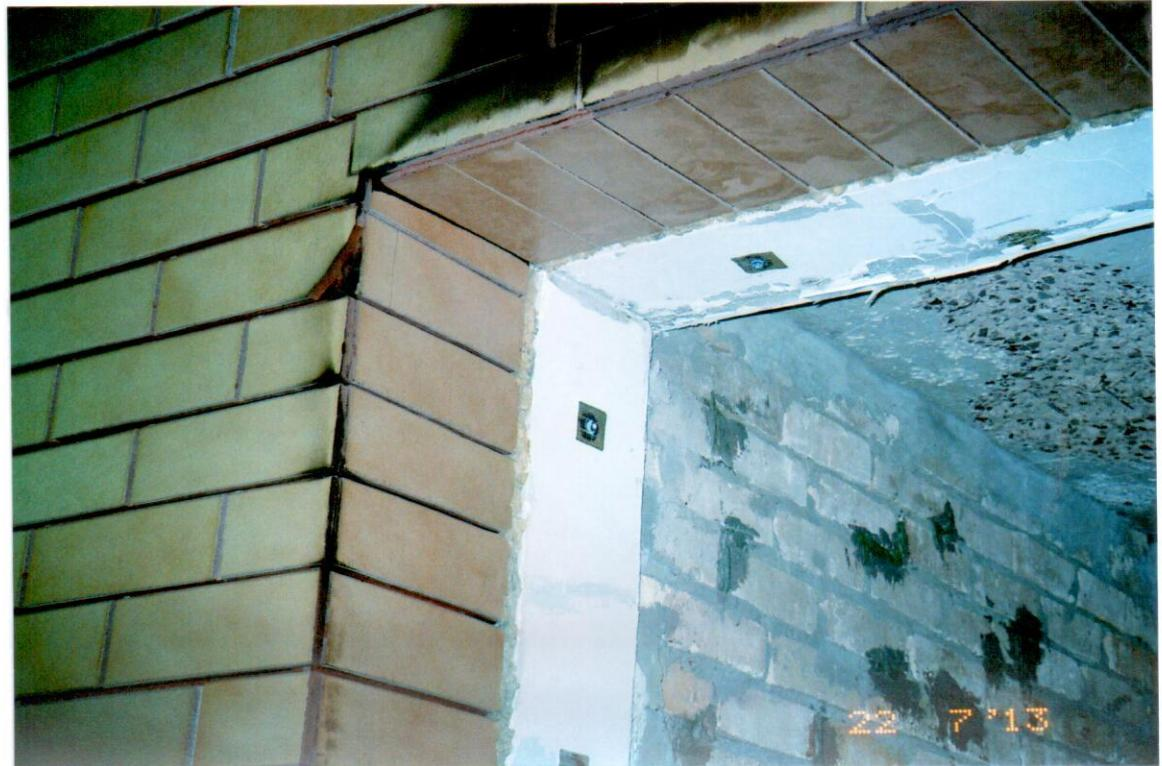
Рис.5.8. Состояние после испытаний «клинкерных» плиток облицовки на левой половине длины верхнего и на левом боковом откосах оконного (огневого) проема образца фасадной системы.
