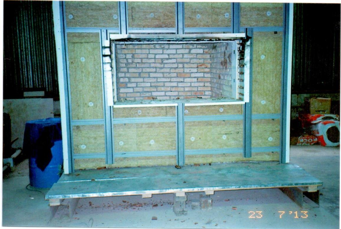
Рис.5.17. Укрупненный вид после испытаний «подконструкций» и утеплителя образца фасадной системы на участках по бокам и вдоль нижнего откоса оконного (огневого) проема.
