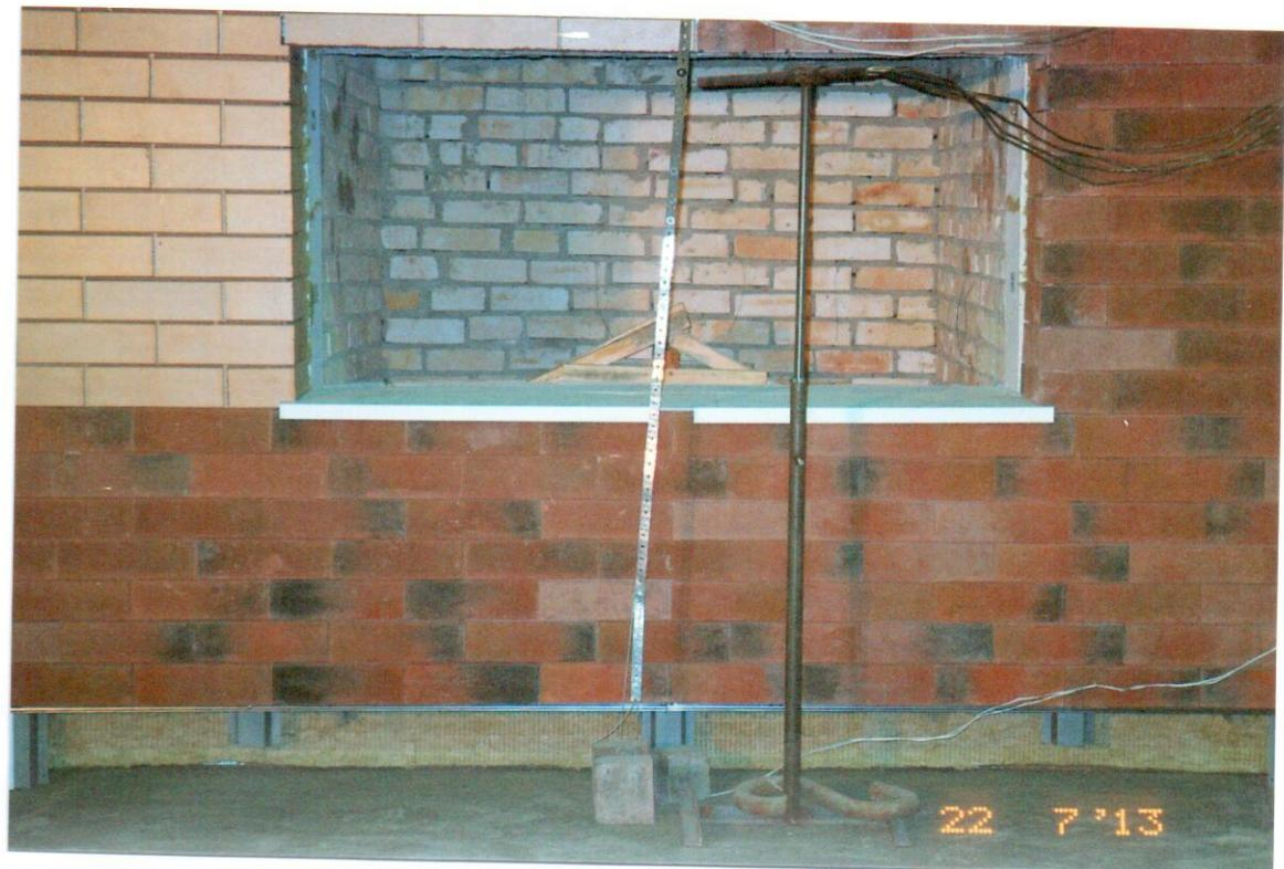
Рис.5.2. Общий вид перед испытаниями участков образца фасадной системы от уровня нижнего торца образца до уровня верхнего откоса оконного (огневого) проема.
