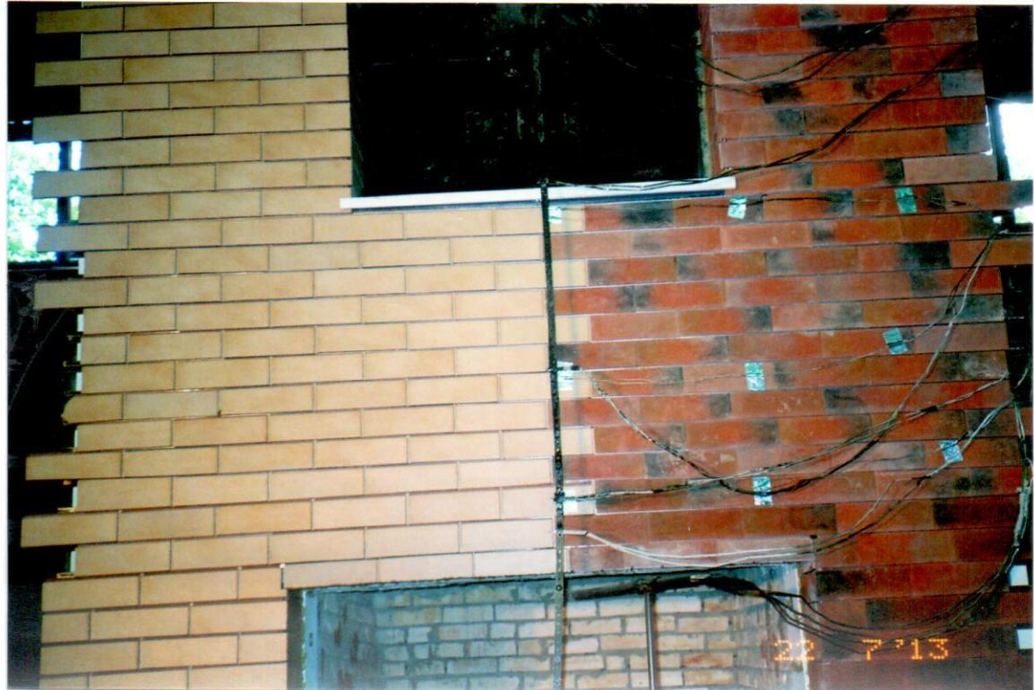
Рис.5.5. Укрупненный вид перед испытаниями участка образца фасадной системы между верхним откосом оконного (огневого) проема и нижним откосом имитации оконного проема.
