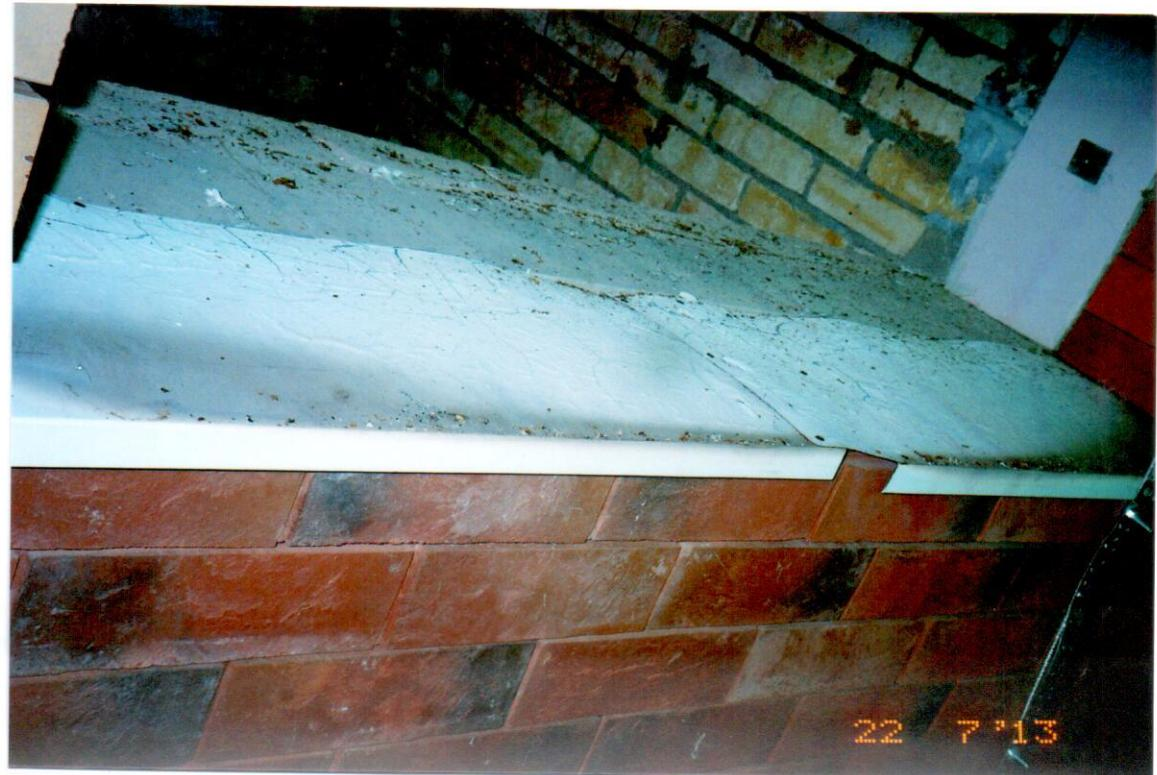
Рис.5.11. Состояние после испытаний стальной панели-слива на нижнем откосе оконного (огневого) проема образца фасадной системы.
