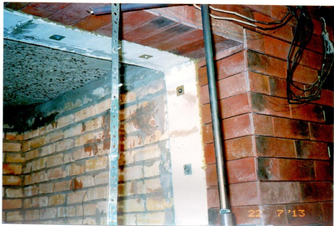
Рис.5.4. Облицовка правой половины длины верхнего и всей длины (высоты) правого бокового откосов оконного (огневого) проема образца фасадной системы плитками из мелкозернистого бетона. Вид перед испытаниями.
