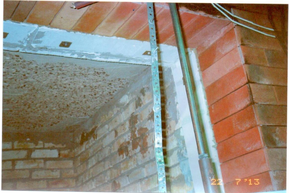
Рис.5.10. Состояние после испытаний плиток облицовки из мелко-зернистого бетона на правой половине длины верхнего и на левом боковом откосах оконного (огневого) проема образца фасадной системы.
