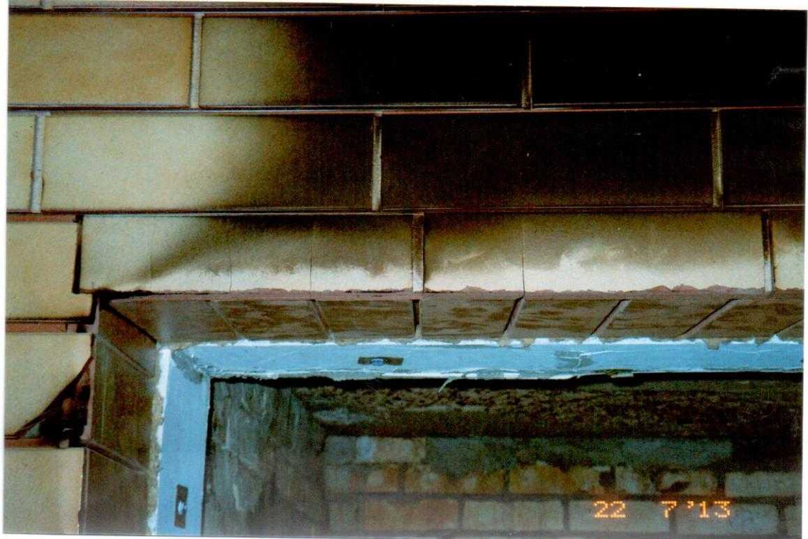
Рис.5.14. Укрупненный вид после испытаний двух «клинкерных» плиток облицовки, расположенных в условно 1-ом горизонтальном ряду непосредственно над верхним откосом оконного (огневого) проема. В этих плитках имеются возникшие уже в процессе испытания вертикальные магистральные волосяные трещины.
