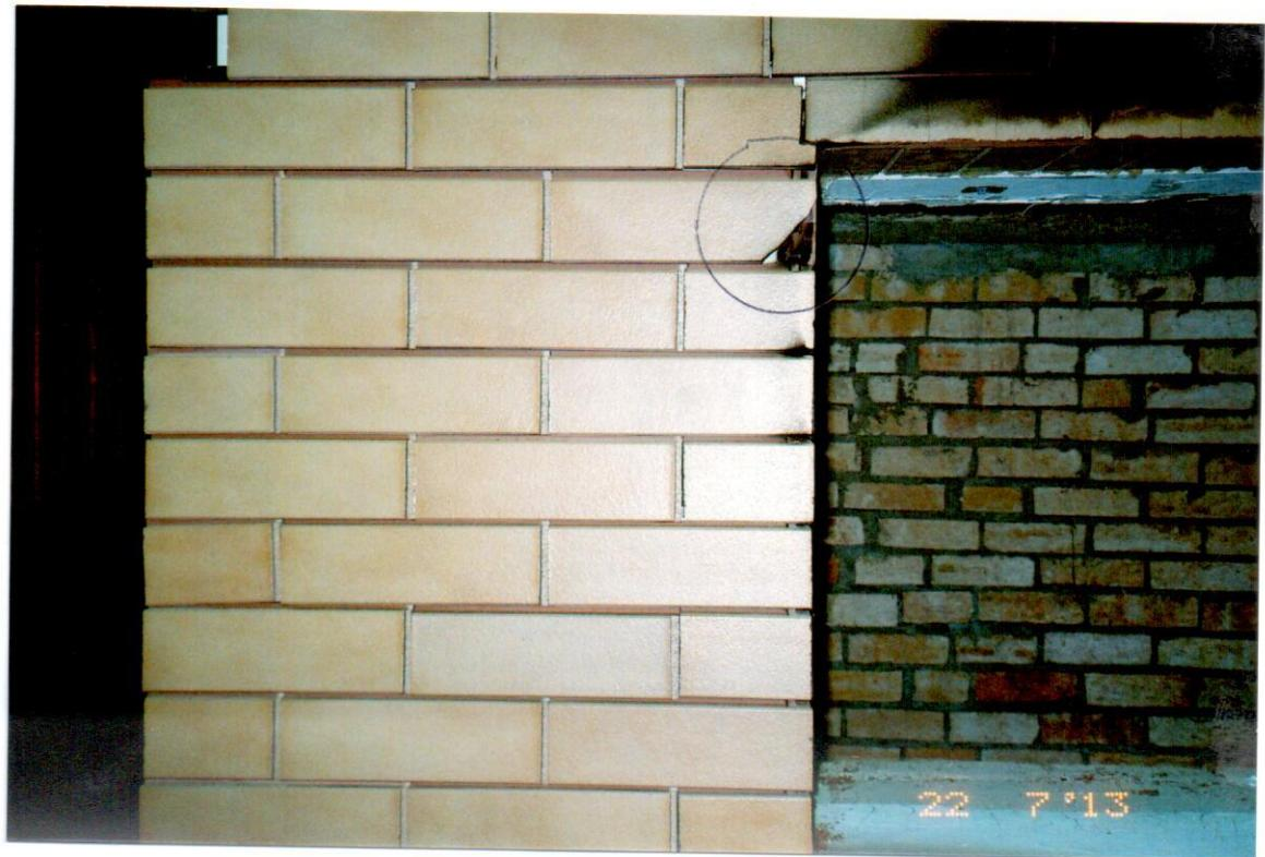
Рис.5.12. Состояние после испытаний «кинкерных» плиток облицовки на участке образца фасадной системы в вертикальном простенке сбоку (слева) от оконного (огневого) проема. [Место откола кусочка треугольной формы из «кинкерной» плитки обозначено  $\circ$ ].
