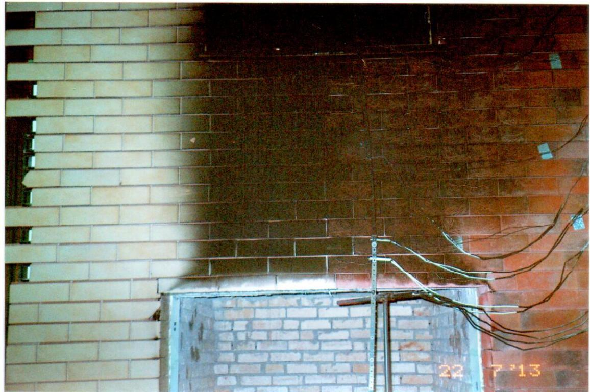
Рис.5.13. Вид после испытаний горизонтального простенка образца фасадной системы между верхним откосом оконного (огневого) проема и нижним откосом имитации оконного проема.
