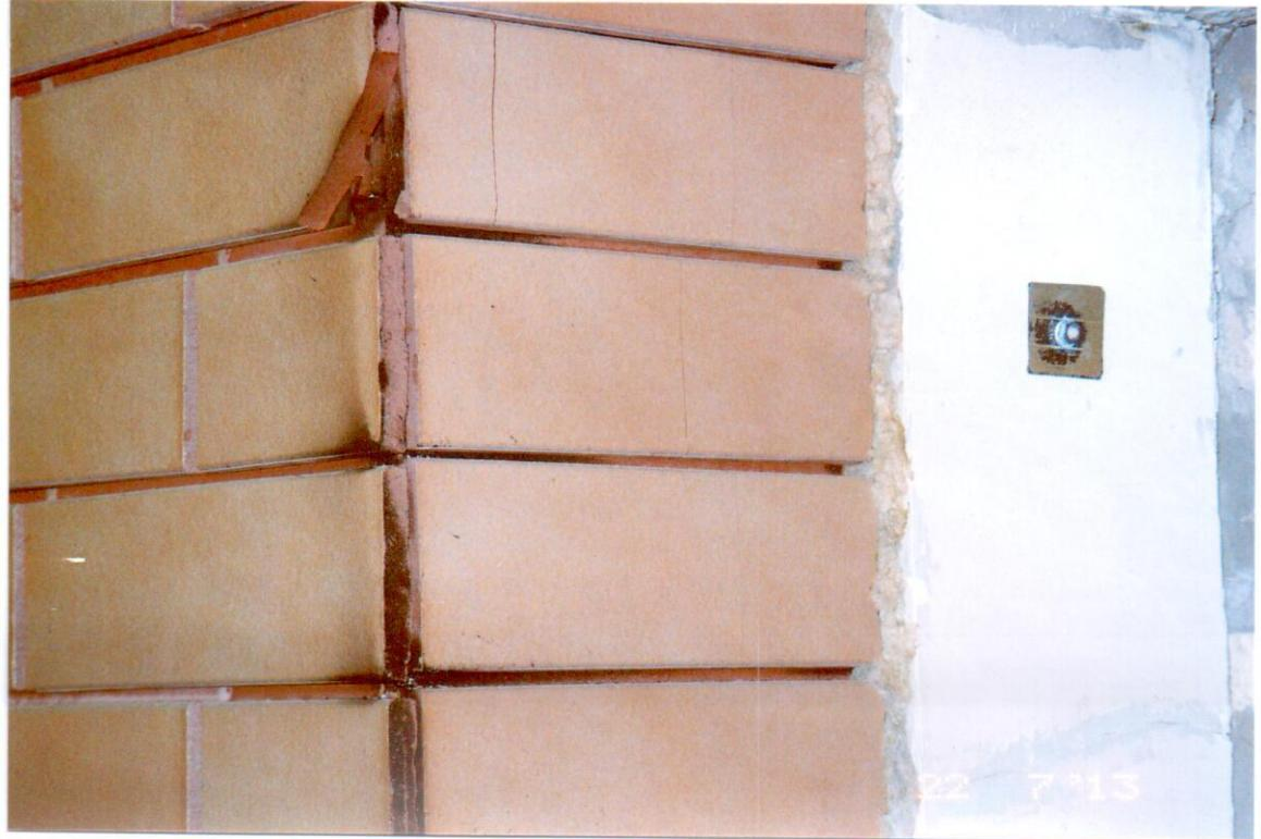
Рис.5.9. Вертикальные магистральные волосяные трещины в верхних трех «кинкерных» плитках облицовки на левом боковом откосе оконного (огневого) проема образца фасадной системы. Вид после испытаний. [Трещины возникли в процессе испытания].
