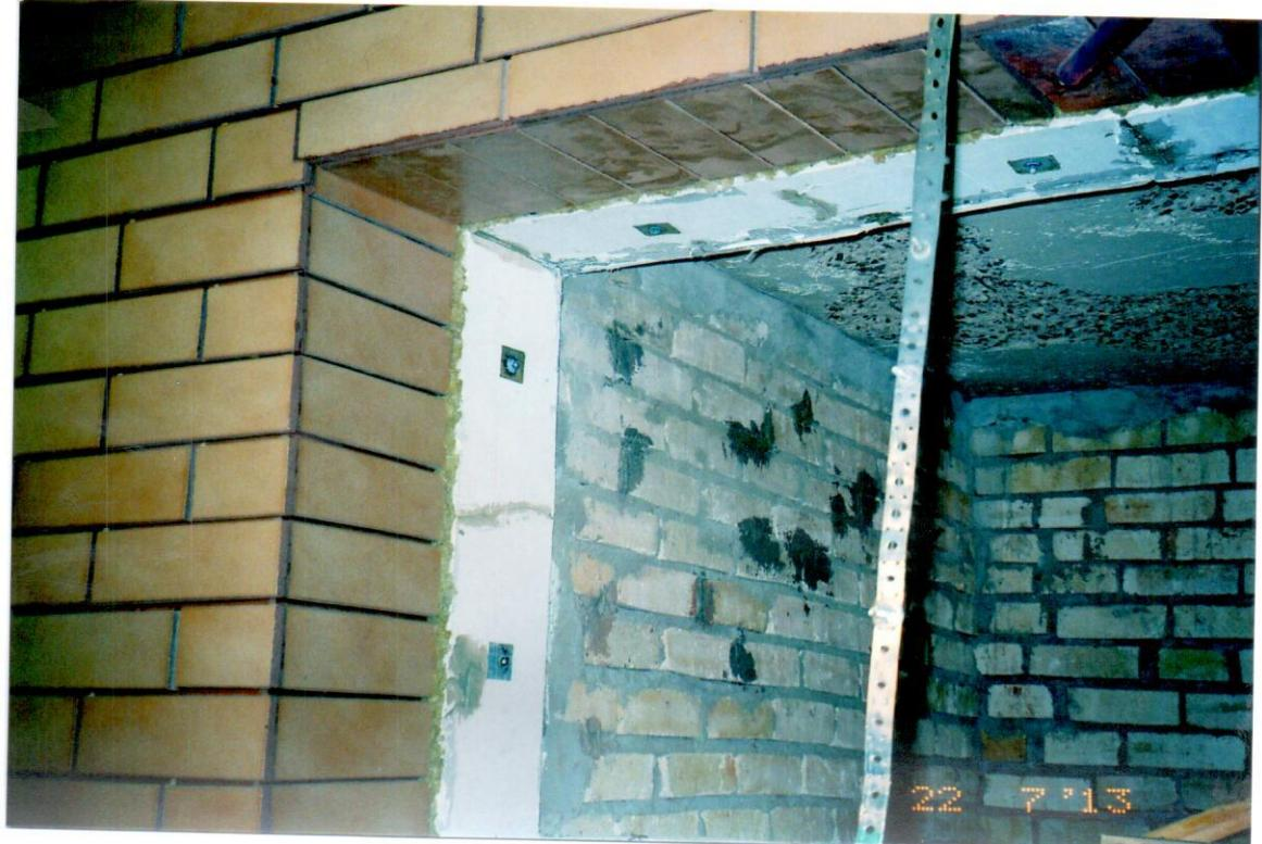
Рис.5.3. Облицовка левой половины длины верхнего и всей длины (высоты) левого бокового откосов оконного (огневого) проема образца фасадной системы «кирзовыми» плитками. Вид перед испытаниями.
