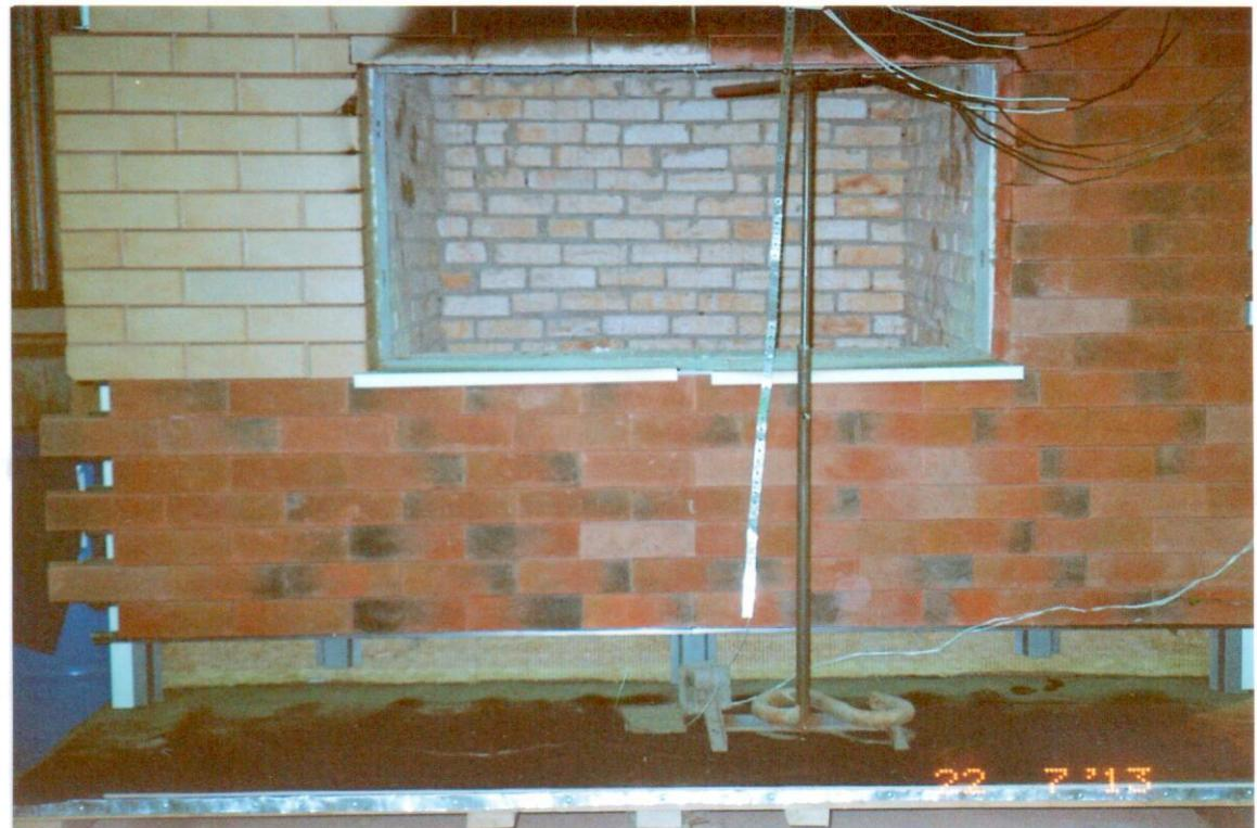
Рис.5.7. Общий вид после испытаний участков образца фасадной системы вдоль боковых и нижнего откосов оконного (огневого) проема.
