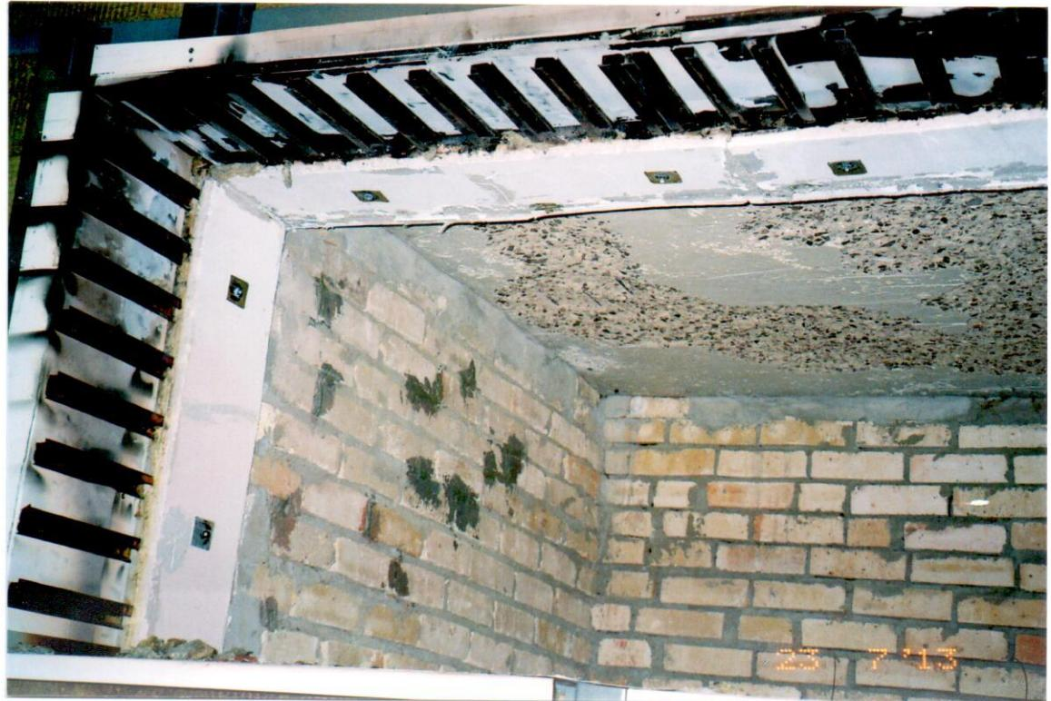
Рис.5.18. Укрупненный вид после испытаний стальных панелей скрытого противопожарного обрамления верхнего и боковых откосов оконного (огневого) проема.
