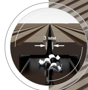
Обеспечивает минимально необходимый зазор между досками
